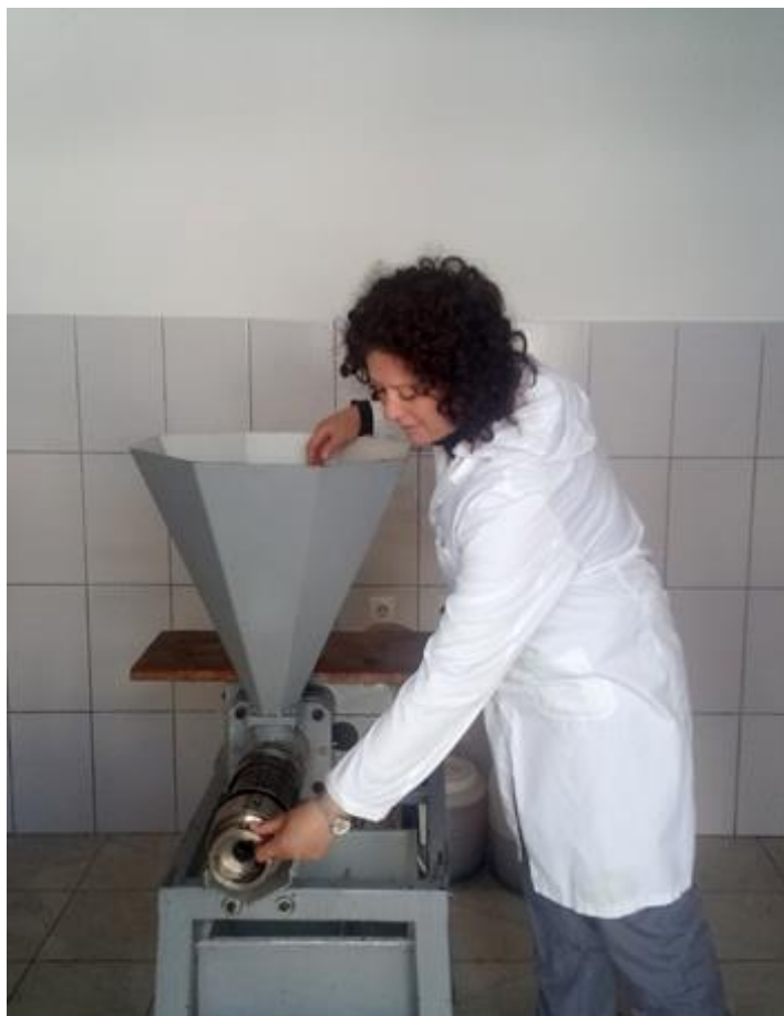
Sl. 3. Institutska uljara, podešavanje prese prije procesa hladnog cijedenja ulja
